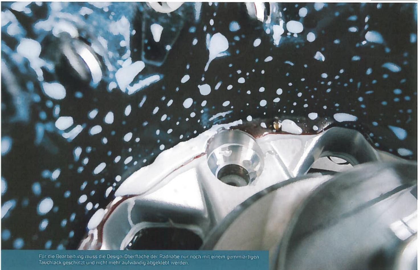
Für die Bearbeitung muss die Design-Oberfläche der Radnabe nur noch mit einem gummiartigen Tauchlack geschützt und nicht mehr aufwändig abgeklebt werden.
