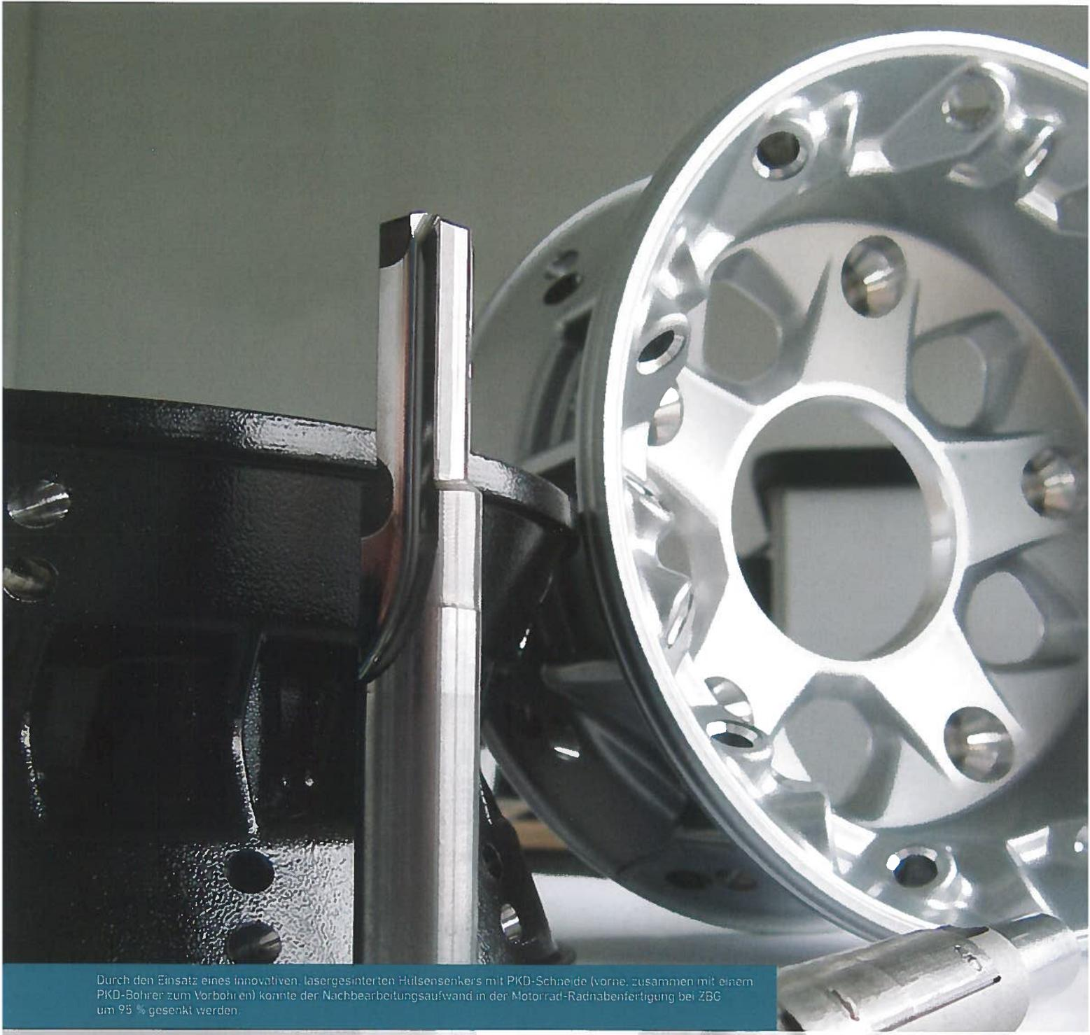
Durch den Einsatz eines innovativen, lasergesinterten Hülssensenkens mit PKD-Schneide (vorne, zusammen mit einem PKD-Bohrer zum Vorbohren) konnte der Nachbearbeitungsaufwand in der Motorrad-Radnabenfertigung bei ZBG um 95 % gesenkt werden.
