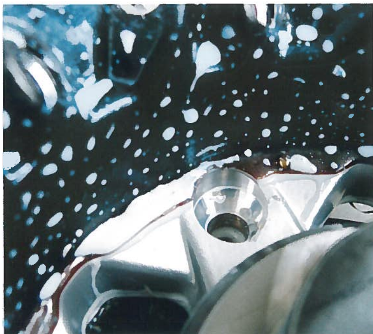
Für die Bearbeitung muss die Design-Oberfläche der Radnabe nur noch mit einem gummiartigen Tauchlack geschützt und nicht mehr aufwändig abgeklebt werden.
