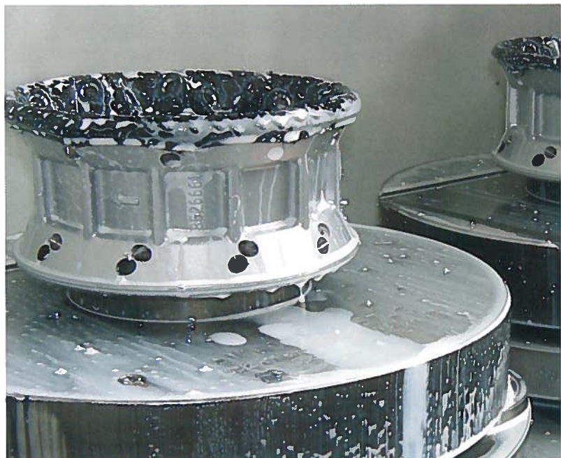
ZBG setzt den MAPAL-Hülsensenker auf Bearbeitungszentren (im Bild) und auf Zweispindelfräsmaschinen mit einer Drehzahl von 6.944 min -1 und einem Vorschub von 840 mm ein.
