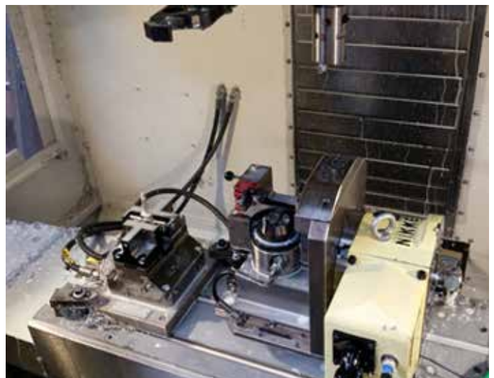
Nikken-Rundtisch mit Vorrichtung bei ZBG
